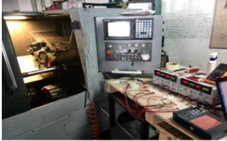
Şekil 3. CNC Torna tezgahı ile irtibatlandırılmış On-line izleme sisteminin görünüşü.
