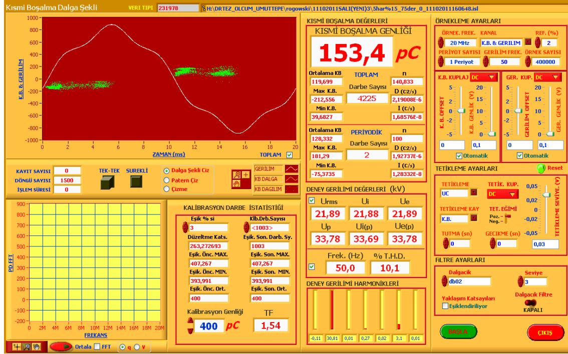
Şekil 7. Faz çözünümlü kısmi boşalma ölçüm sistemi kullanıcı ara yüzü (Phase resolved partial discharge measurement system user interface)
